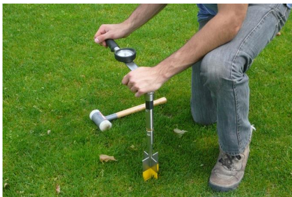
Scherkraftmessung mithilfe eines Drehmomentschlüssels
