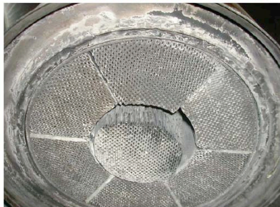
Versagen der Fugenverklebung infolge hoher Schwingungsbelastung
