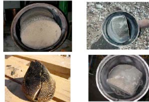
Folge hoher Schwingungsbelastung bei Schwachstellen der Konstruktion
