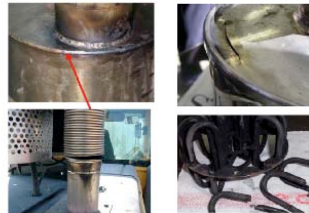
Folge hoher Schwingungsbelastung bei Schwachstellen der Konstruktion
