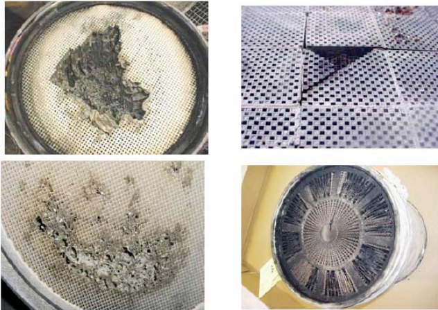
Überhitzungen „Exothermen“ führen zu Brüchen und Schmelzschäden
