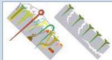
Erosionsschutz Eine vielfältige Vegetation mit standortangepassten Arten umfasst viele verschiedene Wurzeltypen (links). Diese schützen den Boden viel effektiver vor Erosion als wenige, meist flach wurzelnde Arten, wie sie durch schnellwüchsige Mischungen eingebracht werden (rechts). Quelle: Forum Biodiversität Schweiz 2005
